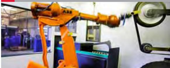
Aplicación de la robótica para solventar el complejo proceso de esmerilado automatizado, asegurando así una calidad homogénea. La más moderna tecnología al servicio de los productos de Teka Sanitary Systems.
