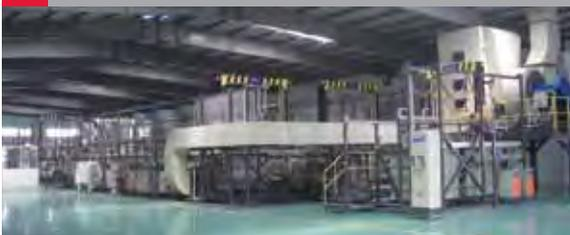
Proceso automatizado de niquelado y cromado con la más avanzada tecnología de protección medioambiental, con medidas implantadas para evitar cualquier tipo de agresión ecológica. Superficie de acabados mediante una capa protectora de cromo altamente resistente y brillo duradero (12,5 micras de Ni-Cr de grosor medio).
