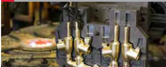
Máquinas de fundición de alta precisión utilizando latón de alta calidad tipo CB755S.
