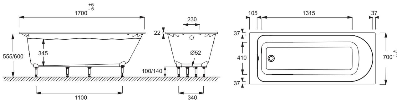
Спецификация продукта : Ванна из материала Flight 170 x 70 см. E6D151. Коллекция : ODEON RIVE GAUCHE. РАЗМЕРЫ (CM) : 170 x 70 x 55.50 см. ВЕС : 46 кг. МАТЕРИАЛ : Flight (композит+акрил). ТИП УСТАНОВКИ : Встраиваемые. VOLUME (L) : 214/144. FORME : Прямоугольные. PRODUIT INCLUS : Ножки в комплекте.
